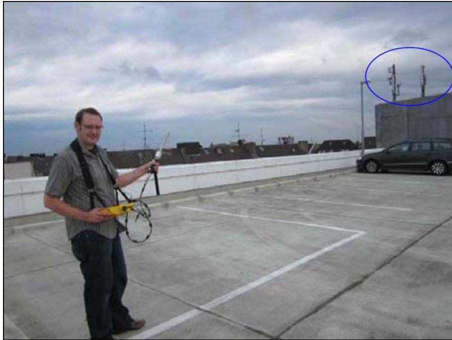
Abb. 9: Messpunkt mit den höchsten LTE- und GSM/UMTS-Immissionen auf dem obersten Parkdeck eines Kaufhauses (Messpunkt 4.3, [6], S. 29)
